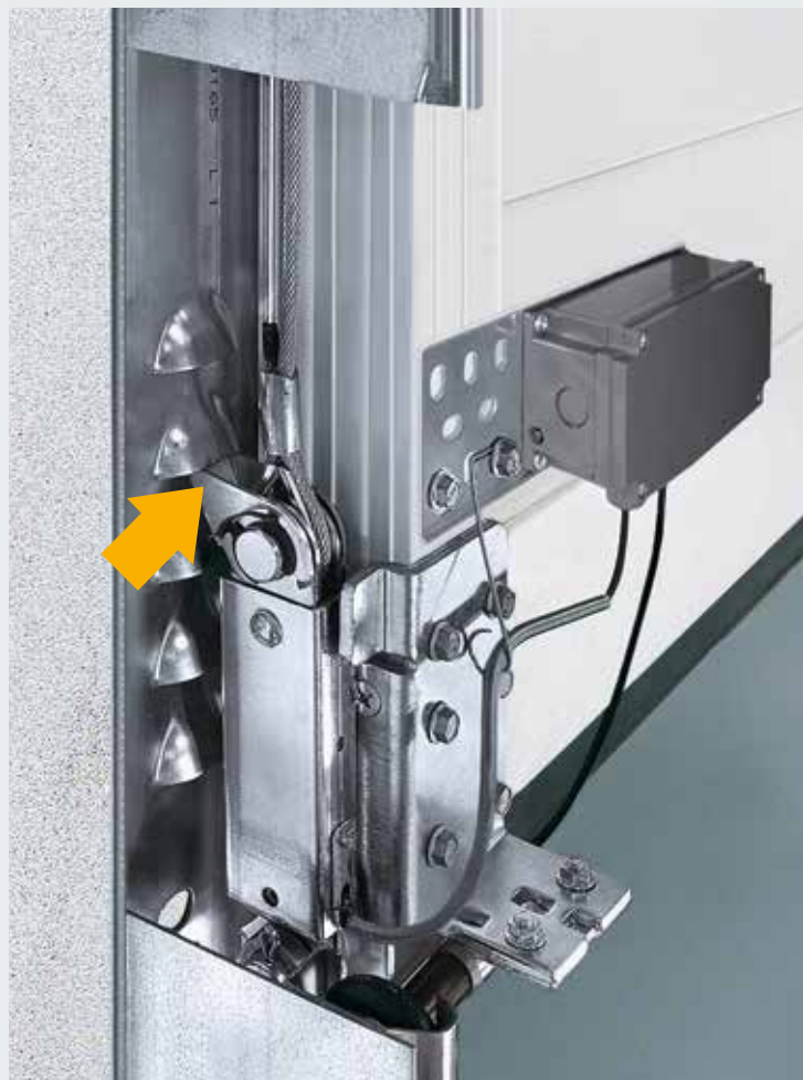
Блокиращата кука на защитата срещу насилствено отваряне щраква автоматично при повдигане на вратата.
