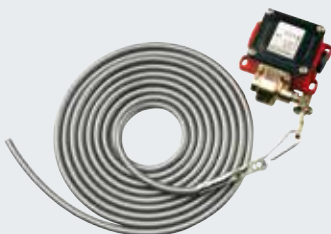
Прекъсвач с шнур и синтетично въже Може да се монтира хоризонтално или вертикално, корпус от алуминиева отливка, IP 65, дължина на въжето 4 м
